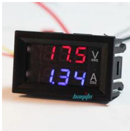
Figure 2.3.2 Digital Volt Meter & Ammeter
