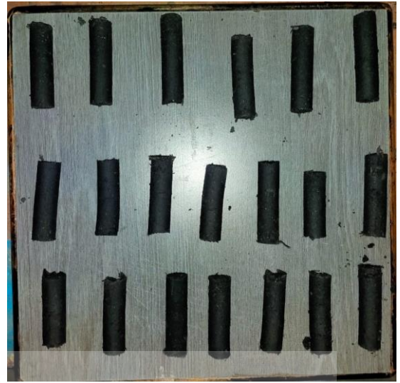
Fig: Sugarcane Briquettes
